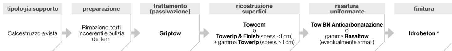
\* Finiture Alternative Consigliate: QUARZOGUM PLUS microrivestimento elastico a film muffa resistente; linea IVASGUM gamma di rivestimenti elastomerici; INTOGUM PLUS rivestimento ad alto potere riempitivo; MURALPAC LISCIO finitura elastomerica alla Pliolite
