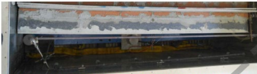
Figura 6. Riproduzione fotografica, al termine degli 80 cicli Heat-Rain, del pannello "TermoK8 Modular Big" all'interno della cella climatica.
