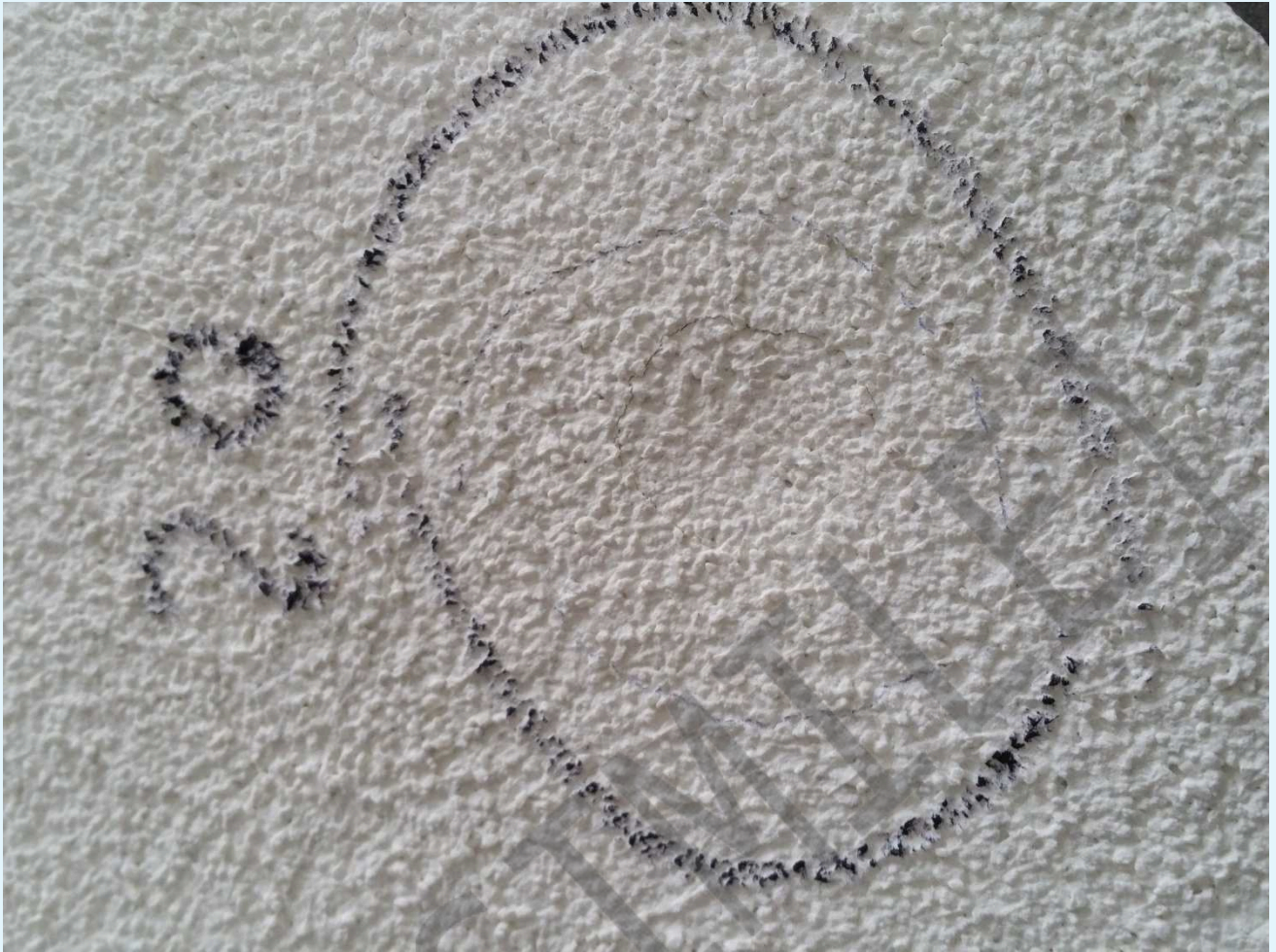
Esempio di ammaccatura con leggera screpolatura superficiale con urto di energia 20 J.
