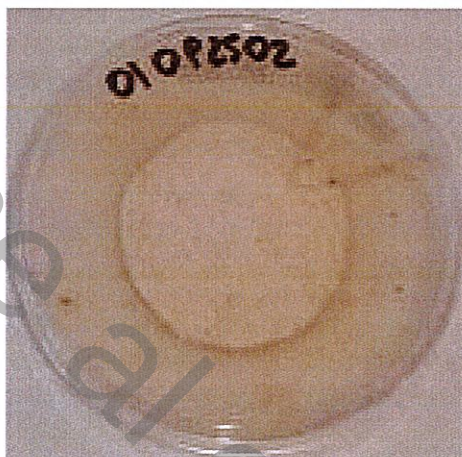
Debolissimo sviluppo algale sul substrato, ma non sul provino
