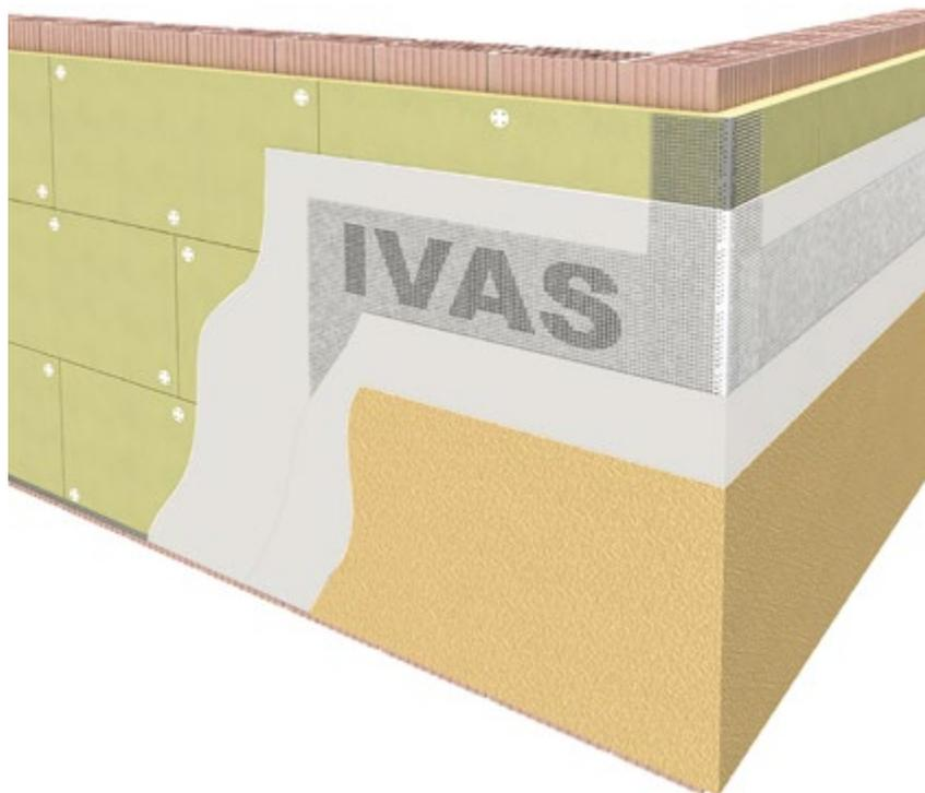
**Soluzione ideale per rivestire ed isolare l'edificio ponendo particolare attenzione alle caratteristiche termoacustiche e di resistenza al fuoco del sistema; è caratterizzato da elevata traspirabilità e da una composizione prevalentemente minerale. La lastra isolante di questo sistema soddisfa i requisiti dei Criteri Ambientali Minimi per l'Edilizia. Reazione al fuoco del sistema: Euroclass A2-s1,d0**
